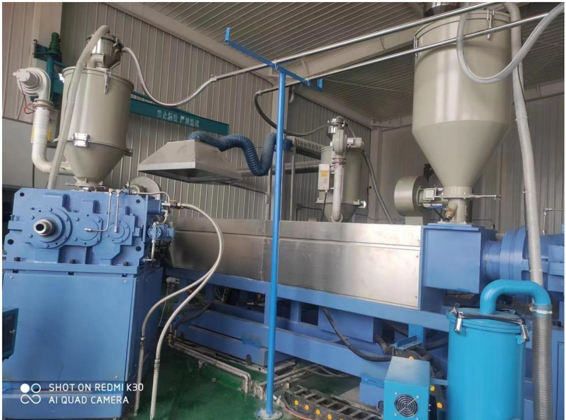
图 2 电缆电线二层绝缘挤出工序
