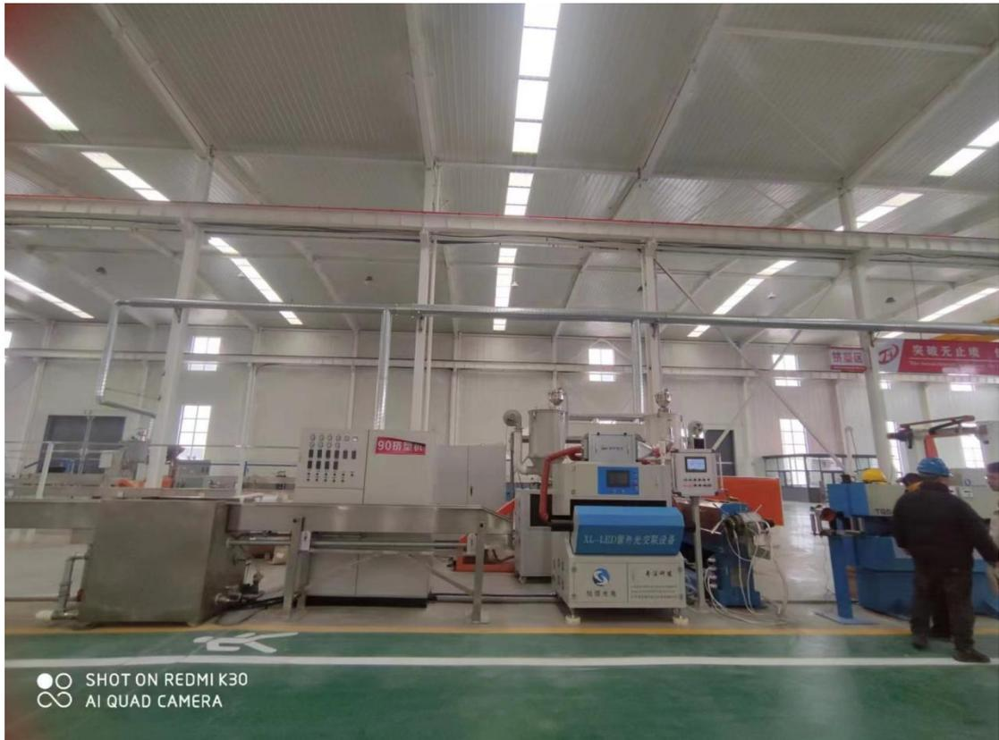
图 3 电缆电线一层绝缘挤出工序
