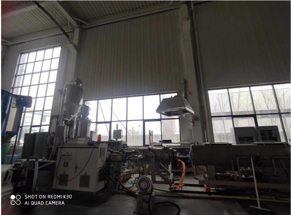
图 1 电缆保护管加热挤出工序
